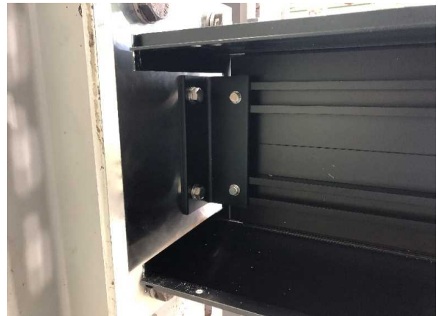
写真5.2・16 上部ブラケットの状態 試験後
