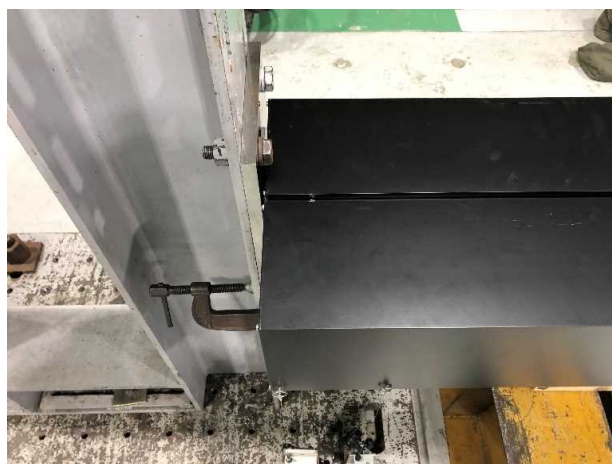
写真5.3・4 試験前状況 マリオン下部
