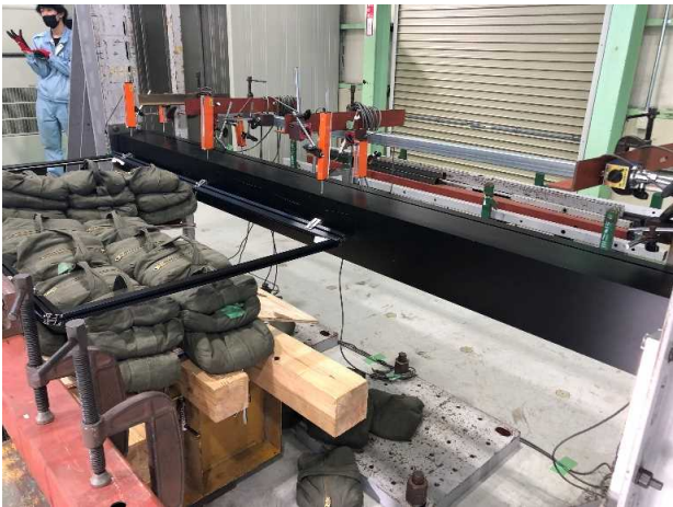
写真5.2・15 5000[N/m 2 ]時 計測後 隔板の抜け
