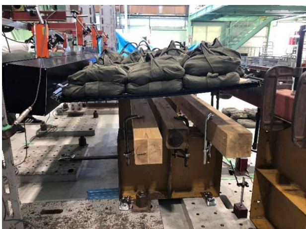
写真5.1・11 3800[N/m 2 ] 載荷時 破壊
