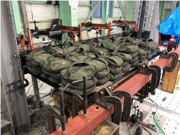
写真5.2・13 5000[N/m 2 ]時 最大変位 \delta = 2.6 [mm]
