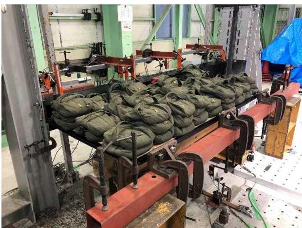
写真5.2.11 4000[N/m 2 ] 載荷時 最大変位 \delta = 1.94 [mm]
