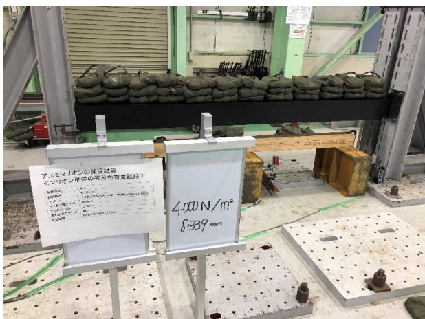
写真5.3.9 4000[N/m 2 ] 载荷時 最大変位 \delta = 33.9 [mm]
