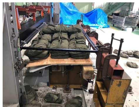
写真4.2.1 5000 [N/m 2 ]測定終了(破壊)時
