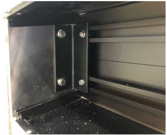
写真5.3・16 下部ブラケットの状態 試験後
