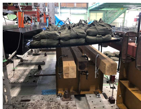
写真4.1・1 3800[N/m 2 ] 载荷 (破壊) 時
