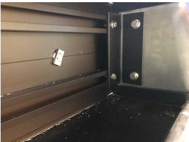
写真5.2・17 下部ブラケットの状態 試験後
