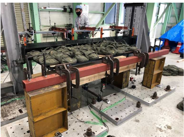
写真5.1.5 2,000 [N/m 2 ] 時 最大変位 \delta = 23.2 [mm]
