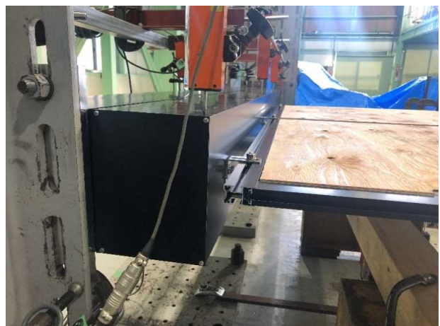
写真5.1.3 試験前状況 マリオン下部
