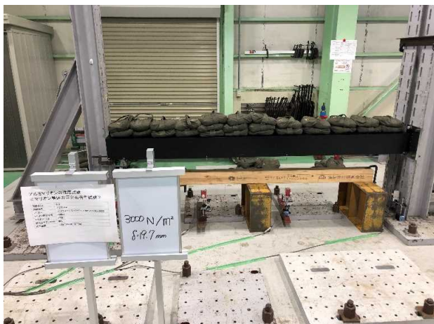
写真5.3.7 3000[N/m 2 ] 载荷時 最大変位 \delta = 19.7 [mm]
