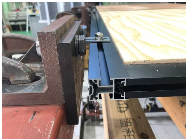
写真5.2.2 縦枠とブラケットの状態
