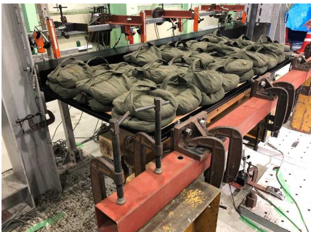
写真5.2.7 2600[N/m 2 ] 載荷時 最大変位 \delta = 1.14 [mm]
