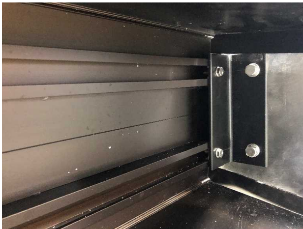
写真5.3・15 上部ブラケットの状態 試験後
