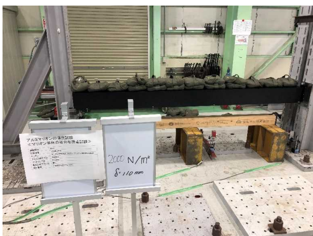
写真5.3・5 2,000[N/m 2 ]時 最大変位 \delta = 11.0 [mm]
