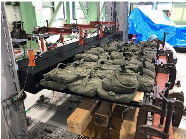
写真5.1・7 2600[N/m 2 ] 載荷時 最大変位 \delta = 33.6 [mm]
