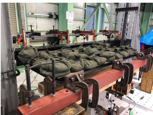
写真5.2.5 2,000[N/m 2 ]時 最大変位 \delta = 0.86 [mm]
