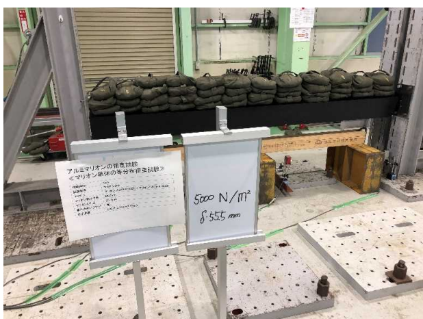
写真5.3.11 5000[N/m 2 ] 载荷時 最大変位 \delta = 55.5 [mm]
