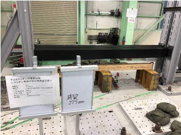
写真5.3・13 荷重除去 残留 \delta = 27.5 [\text{mm}]
