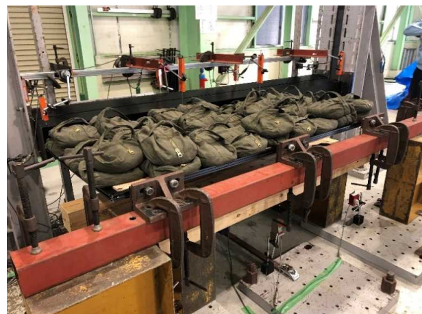
写真5.1・9 3000[N/m 2 ] 載荷時 最大変位 \delta = 39.3 [mm]
