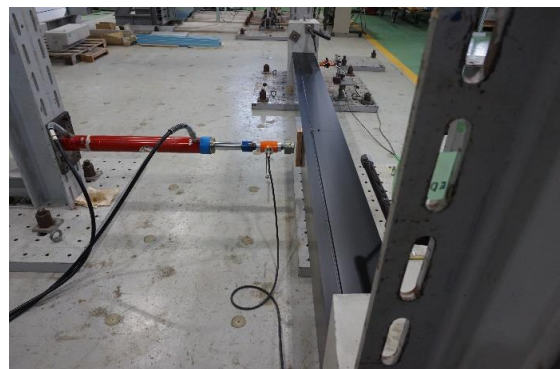
写真5.2.14 2,950[N/本]荷重除荷後の試験体状況
