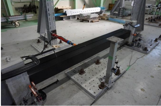
写真5.1-23 4,500[N/本]時 最大変位 \delta = 7.7 [mm]
