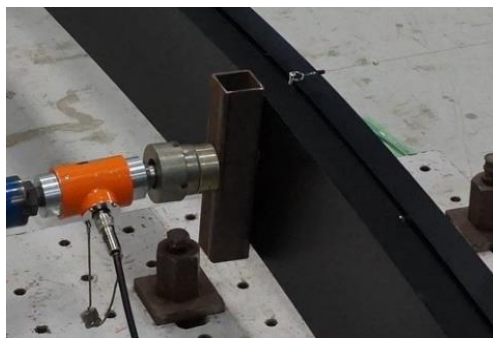
写真4.3・3 【変更後】鋼製の角パイプ
