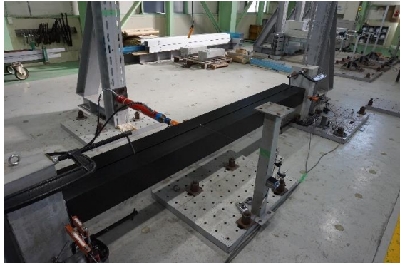
写真5.1.15 2,950[N/本]時 最大変位 \delta = 4.1 [mm]
