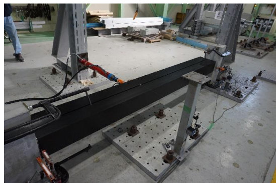
写真5.1.19 2,950[N/本]荷重除荷後の試験体状況 残留 \delta = 2.4 [mm]
