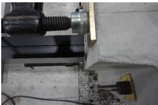
写真5.3・23 4,500[N/本]荷重除荷後の試験体状況 マリオン下部
