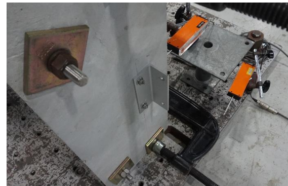
写真5.2・28 試験後のブラケット状況 マリオン上部
