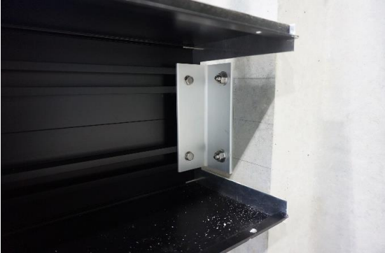
写真5.1・31 試験後のブラケット状況 マリオン下部
