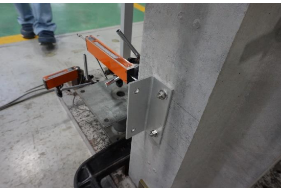
写真5.1・33 試験後のブラケット状況 マリオン下部
