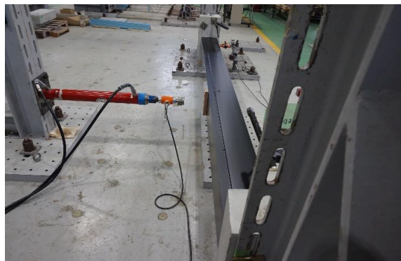
写真5.2-22 4,500[N/本]荷重除荷後の試験体状況
