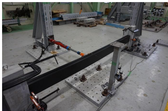
写真5.3・9 2,950[N/本]時 最大変位 \delta = 38.3 [mm]
