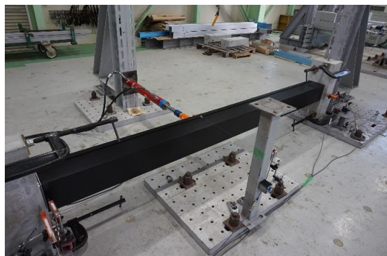
写真5.2.9 2,950[N/本]時 最大変位 \delta = 5.8 [mm]
