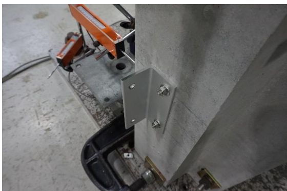
写真5.3・35 試験後のブラケット状況 マリオン下部
