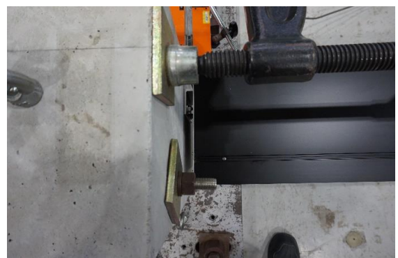
写真5.2-24 4,500[N/本]荷重除荷後の試験体状況 マリオン上部
