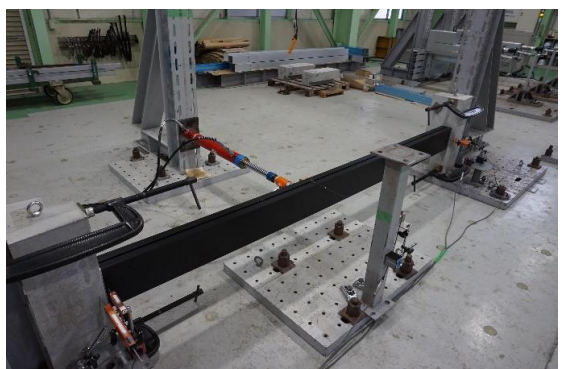
写真5.3・5 1,450 [N/本] 時 最大変位 \delta = 15.2 [mm]
