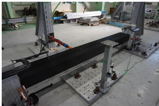
写真5.1-27 4,500[N/本]荷重除荷後の試験体状況 残留 \delta = 3.5 [mm]
