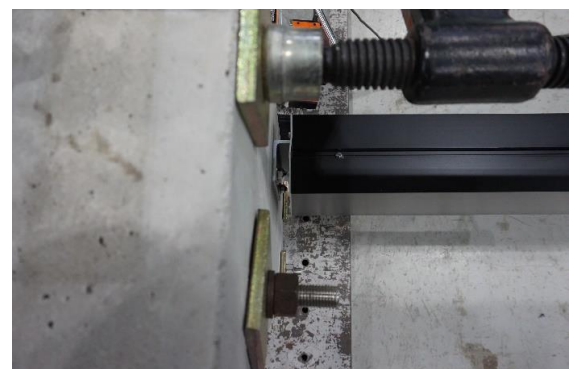
写真5.3・32 荷重除荷後の試験体状況 マリオン上部
