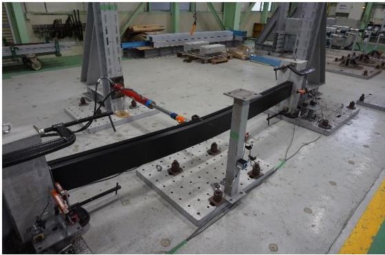
写真5.3・25 最大荷重 5,413[N/本]時 最大変位 \delta = 112.4 [mm]
