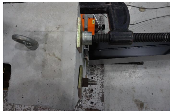
写真5.3・28 最大荷重 5,413[N/本]時 マリオン上部
