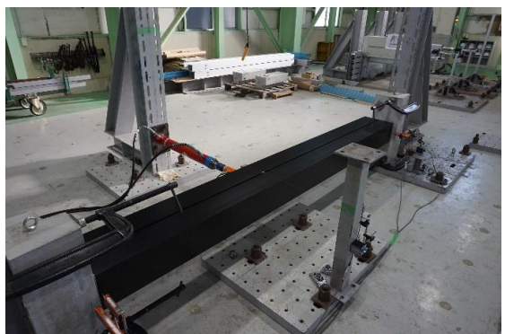
写真5.1.11 1,450[N/本]時 最大変位 \delta = 1.7 [mm]
