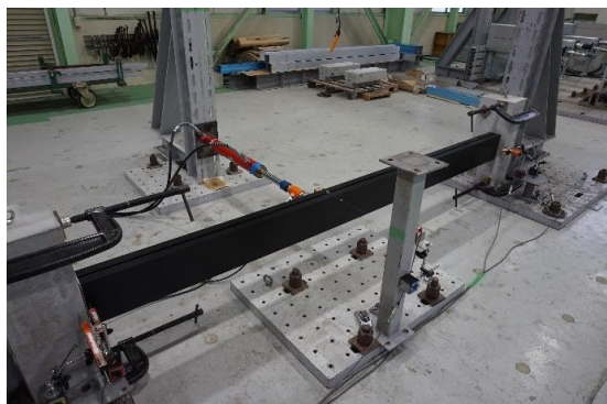
写真5.3・21 4,500[N/本]荷重除荷後の試験体状況 残留 \delta = 14.2 [mm]
