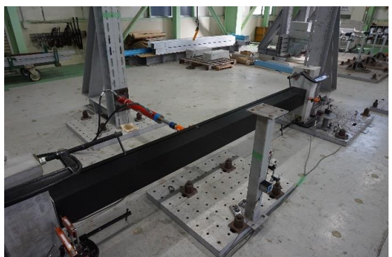
写真5.2・5 1,450[N/本]時 最大変位 \delta = 2.3 [mm]
