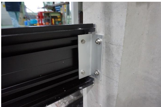
写真5.3・33 試験後のブラケット状況 マリオン下部
