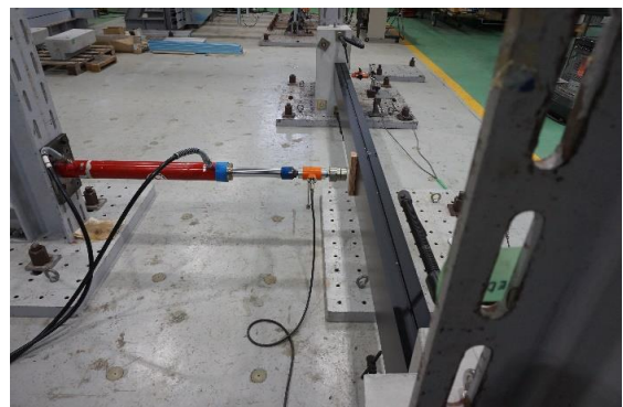
写真5.3・14 2,950[N/本]荷重除荷後の試験体状況
