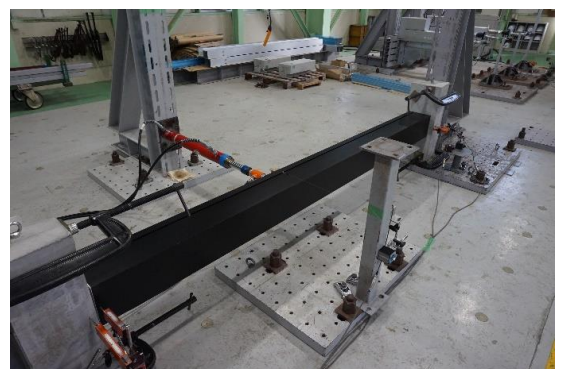
写真5.2.13 2,950[N/本]荷重除荷後の試験体状況 残留 \delta = 1.5 [mm]
