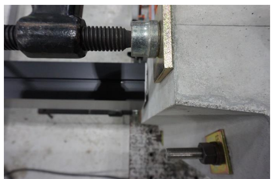
写真5.3・15 2,950[N/本]荷重除荷後の試験体状況 マリオン下部
