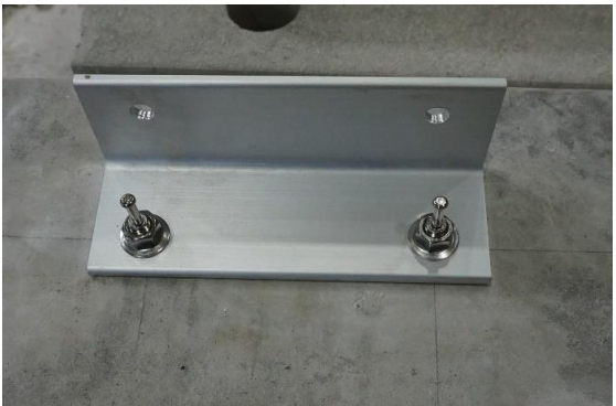
写真5.1・5 試験前状況 アンカーボルト
