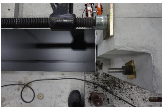
写真5.2-23 4,500[N/本]荷重除荷後の試験体状況 マリオン下部
