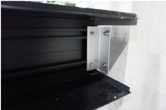
写真5.2・25 試験後のブラケット状況 マリオン下部
