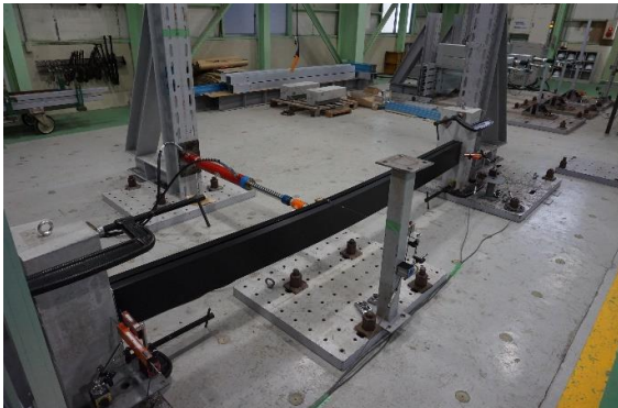
写真5.3・17 4,500[N/本]時 最大変位 \delta = 77.6 [mm]
