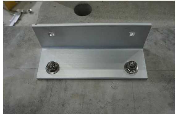
写真5.1・6 試験前状況 アンカーボルト
