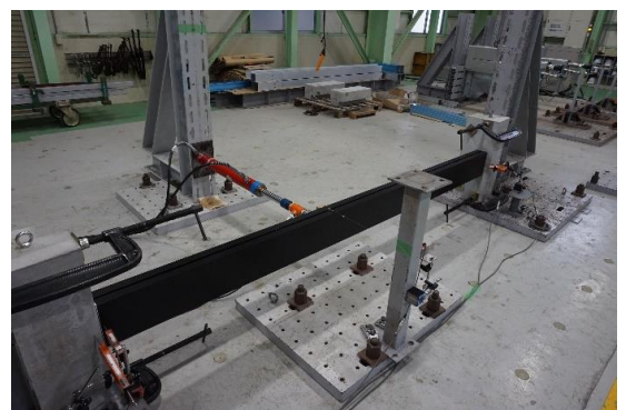
写真5.3・13 2,950[N/本]荷重除荷後の試験体状況 残留 \delta = 2.8 [mm]
