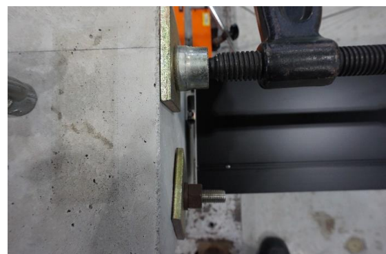
写真5.2.16 2,950[N/本]荷重除荷後の試験体状況 マリオン上部
