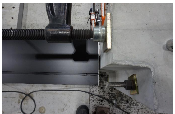
写真5.2.15 2,950[N/本]荷重除荷後の試験体状況 マリオン下部
