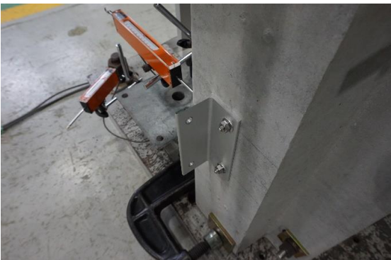
写真5.2・27 試験後のブラケット状況 マリオン下部
