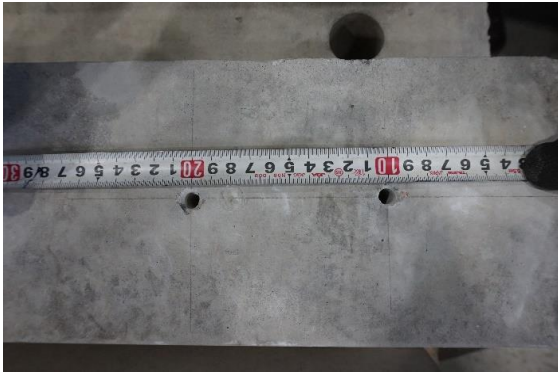
写真5.1・1 試験前状況 アンカーボルト 溝穴
