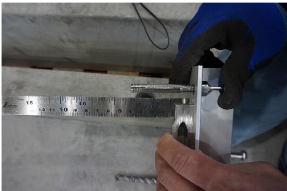
写真5.1・3 試験前状況 アンカーボルト
